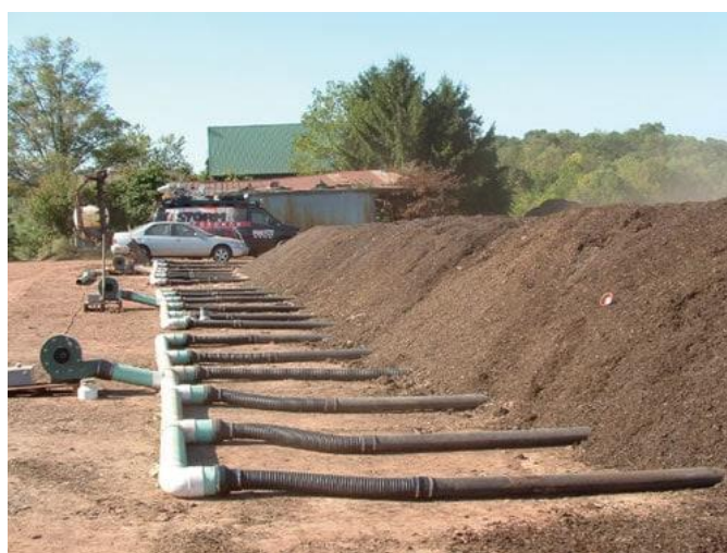
Slika 2.5. Kompostiranje u hrpi ili stogu s prisilnom aeracijom. 60
