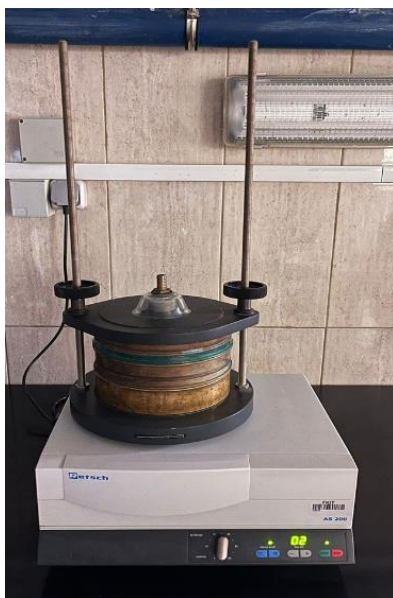
Slika 15. Fotografija uređaja za potresivanje sita AS 200 (Retsch GmbH, Haan, SR Njemačka).
