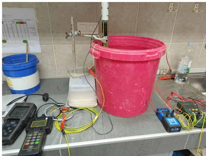
Slika 16. Sustav s katodnom zaštitom žrtvovanom anodom spreman za mjerenje ON-OFF (uključno-isključnog) potencijala opisanim postupkom pri čemu je elektrolit vodovodna voda
