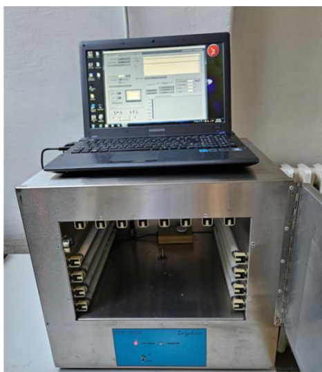
Slika 37. Fotokemijski reaktor CCP-ICH2 proizvođača Luzchem
