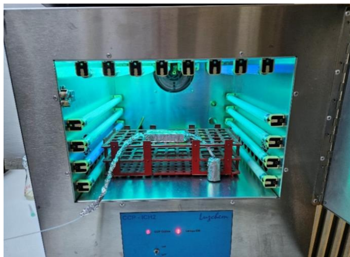
Slika 41. Fotokemijski reaktor s upaljenim UV lampama
