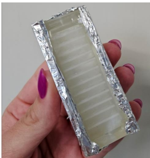
Slika 39. Reaktor obložen aluminijskom folijom
