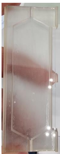
Slika 33. 3D-ispisan reaktor tehnologijom SLA od materijala High Temp (Formlabs) (reaktor smanjenog volumena)
