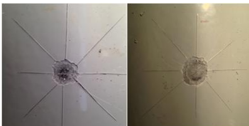
Slika 4.15. Test na katodno odvajanje oštećenja promjera 6,5 mm i 13 mm za sustav S2 u atmosferskoj zoni
