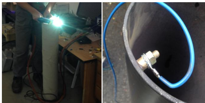
Slika 3.6. Zavarivanje kablova na uzorke
