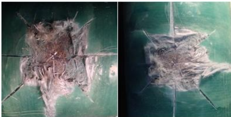
Slika 4.23. Test na katodno odvajanje oštećenja promjera 6,5 mm i 13 mm za sustav S5 u zoni uronjenosti
