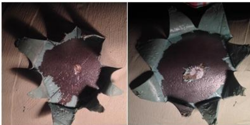
Slika 4.20. Test na katodno odvajanje oštećenja promjera 6,5 mm i 13 mm za sustav S4 u zoni uronjenosti
