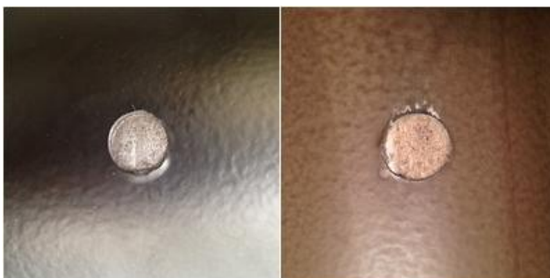
Slika 4.2. Izgled oštećenja sustava S1 promjera 13 mm prije i nakon izlaganja NaCl – u
