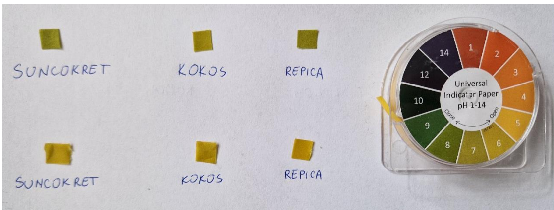
Slika 21. pH biodizela; gornji red – ispitivani biodizeli; donji red – pročišćeni biodizeli
