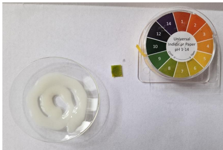
Slika 19. Izdvojeni donji sloj iz sustava voda – glicerol – FABE 1. Desno je univerzalni indikatorski papir.
