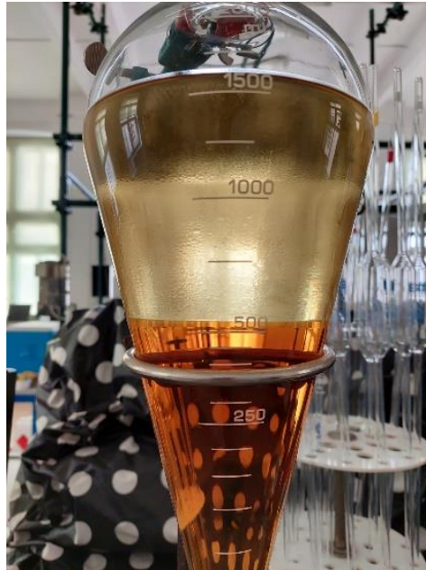
Slika 5. Biodizel kao produkt transesterifikacije iz kupovnog suncokretovog ulja
