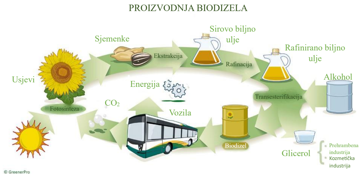
Slika 3. Kružni ciklus dobivanja, proizvodnje i primjene biodizela.[6]
