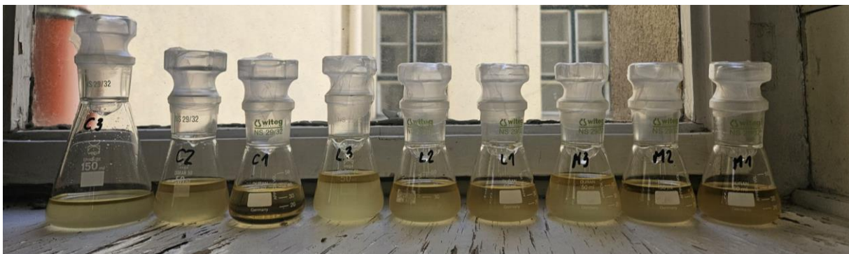
Slika 25. Prikaz odvojenih faza smjesa sirovog glicerola i hidrofilnih DES – ova
