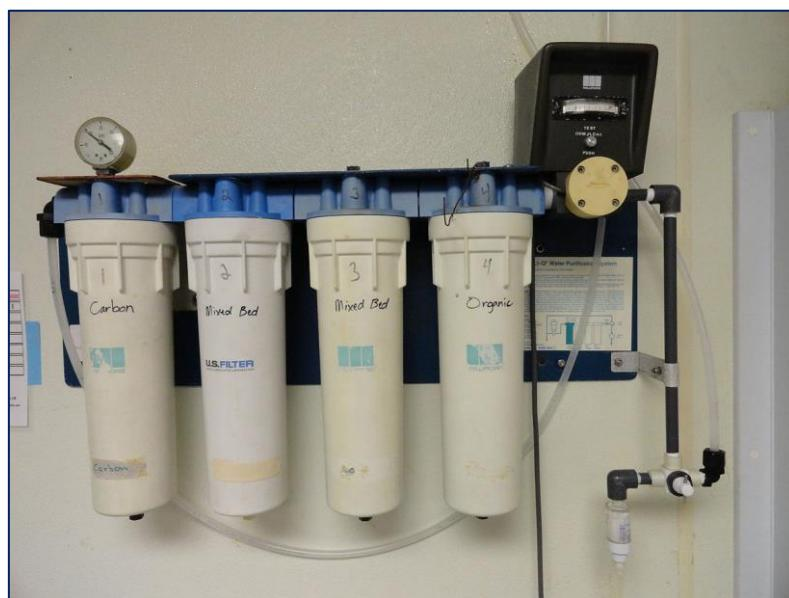
Slika 10. Korištena aparatura za dobivanje ultračiste vode.
