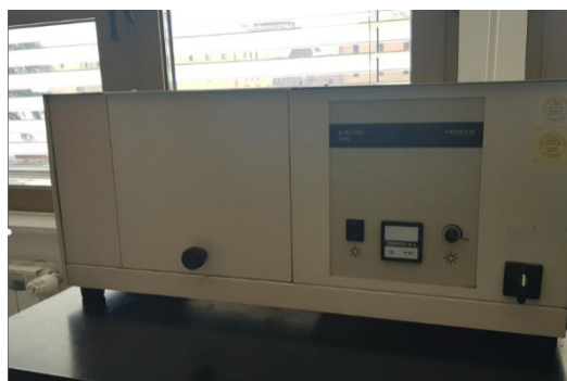
Slika 15. UV komora SUNTEST
