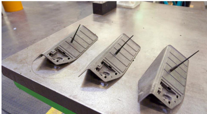
Slika 13. Dijelovi automobila tvrtke Ford izrađeni od recikliranog PP biokompozita ojačanog otpadom masline.[36]
