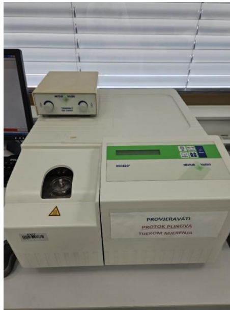
Slika 9. Diferencijalni pretražni kalorimetar Mettler Toledo 385e
