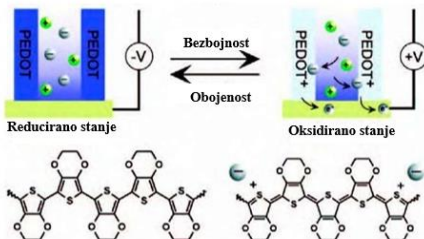
Slika 2.16. Prikaz procesa elektrokromnog učinka PEDOT-a [26]
