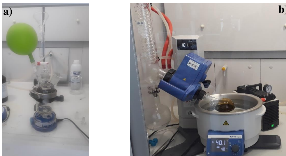
Slika. 3.4. a) Sinteza PEDOT-Br makroinicijatora; b) rotacijski uparivač
