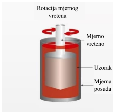
Slika 13. Prikaz rotacijskog reometra s geometrijom „koncentričnih cilindara“
