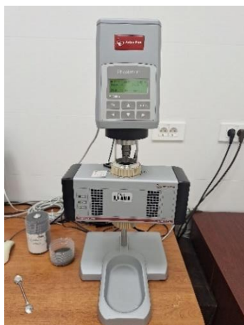
Slika 18. Rotacijski reometar RheolabQC
