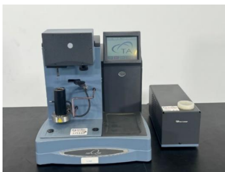
Slika 21. TGA uređaj TA Instruments Q500
