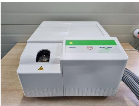
Slika 20. DSC uređaj MetlerToledo DSC 823e
