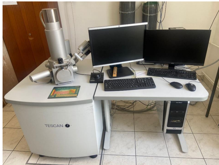
Slika 16. Pretražni elektronski mikroskop SEM Tescan Vega 3
