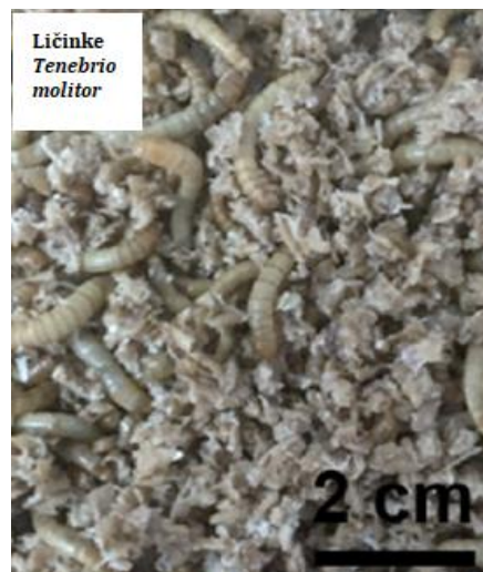
Slika 10. Prikaz ličinki Tenebrio molitor tijekom razgradnje PLA 14
