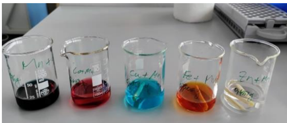
Slika 15. Monolitni nosači uronjeni u impregnacijske otopine.
