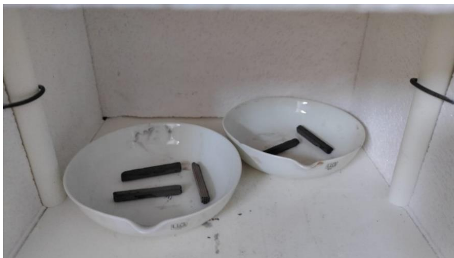
Slika 17. Monolitni nosači nakon kalciniranja.
