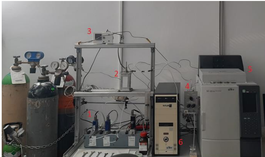
Slika 18. Sustav za katalitičku oksidaciju BTEX spojeva.
