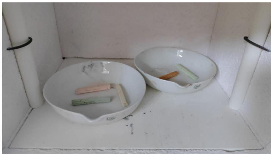
Slika 16. Monolitni nosači prije kalciniranja.
