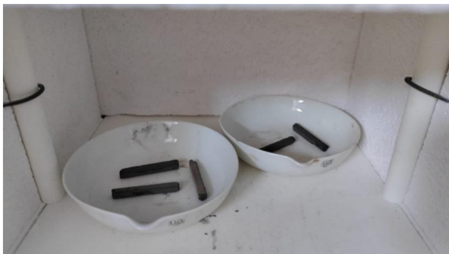
Slika 17. Monolitni nosači nakon kalciniranja.
