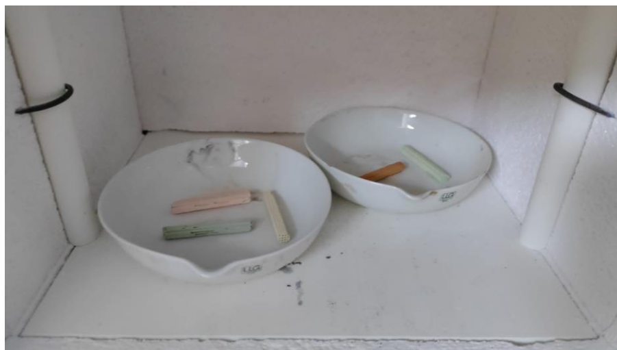
Slika 16. Monolitni nosači prije kalciniranja.
