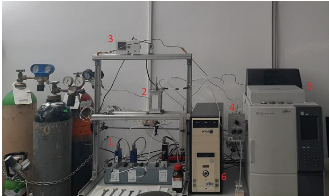
Slika 18. Sustav za katalitičku oksidaciju BTEX spojeva.
