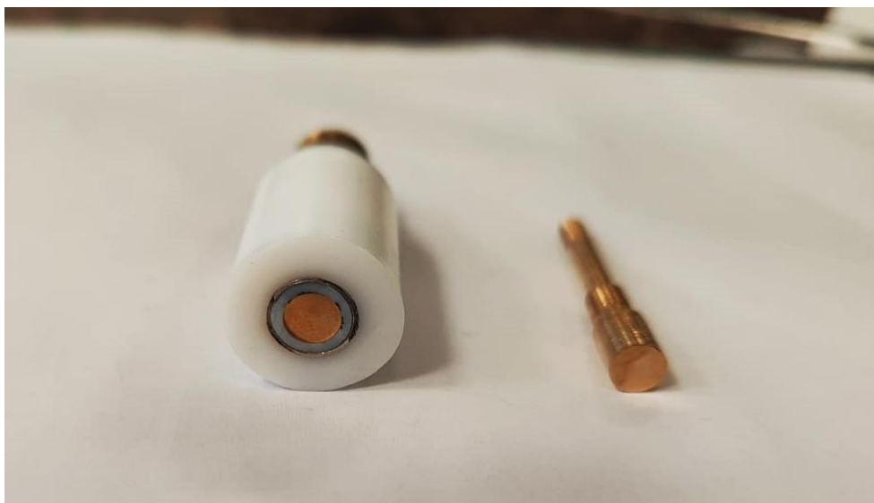
Slika 3.2. Disk elektroda od bronce.
