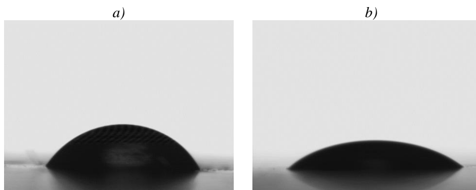
Slika 20. Kapljice testnih kapljevina a) voda i b) dijodometan na pločici PCL polimera
