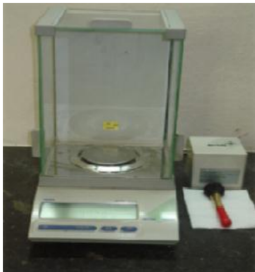
Slika 17. Analitička vaga Mettler Toledo, AB104, Švicarska
