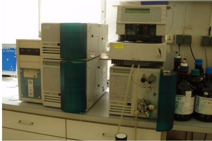
Slika 22. Tekućinski kromatograf visoke djelotvornosti ProStar
