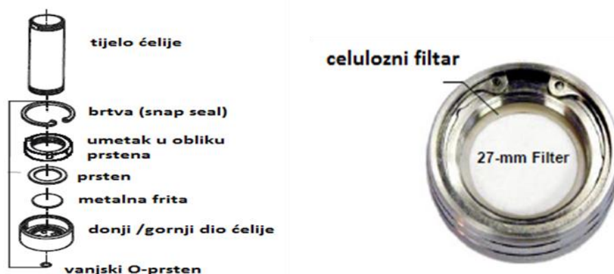
Slika 12. Shematski prikaz ASE ćelije
