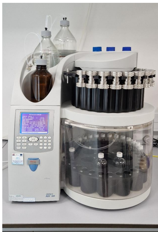
Slika 13. Uređaj za ekstrakciju pri povišenom tlaku i temperaturi, ASE
