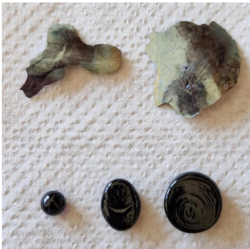
Slika 21. Djelomično kristalizirano staklo Li-30Fe (gore) i potpuno amorfno staklo Na-30Fe (dolje)
