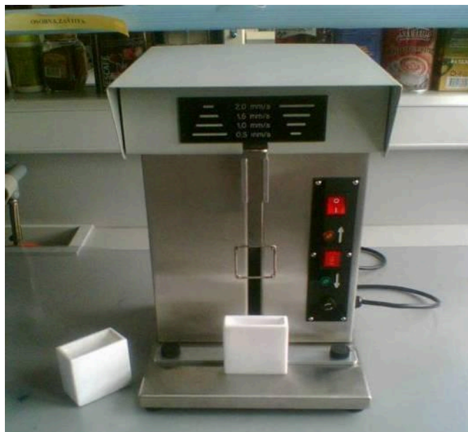
Slika 21. Aparatura za uranjanje vlastite izrade, (Zavod za materijale, vlakna i ispitivanje tekstila, TTF)
