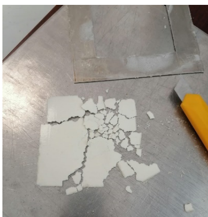
Slika 23. Uzorak prešanog PVP praha
