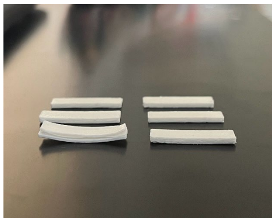
Slika 53. Prikaz TPU pločica nakon testa bubrenja slikan iz drugog kuta
