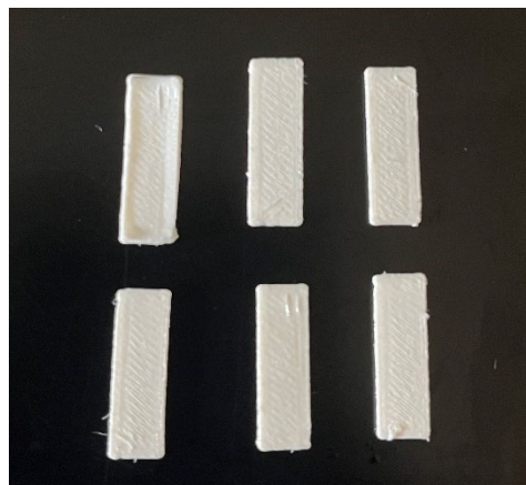
Slika 52. Prikaz TPU pločica nakon testa bubrenja
