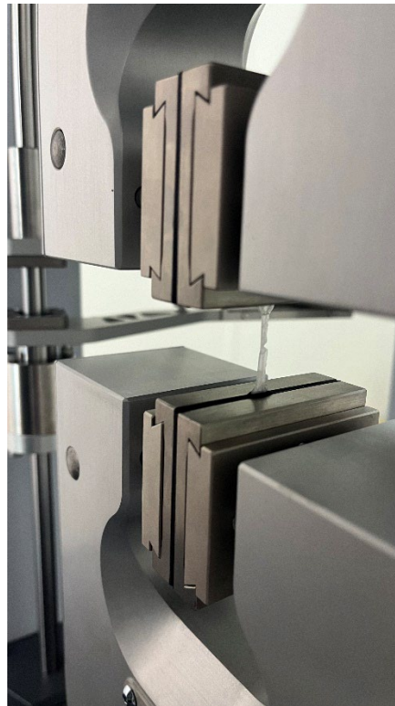
Slika 39. Prikaz puknute epruvete na jednom dijelu vrata
