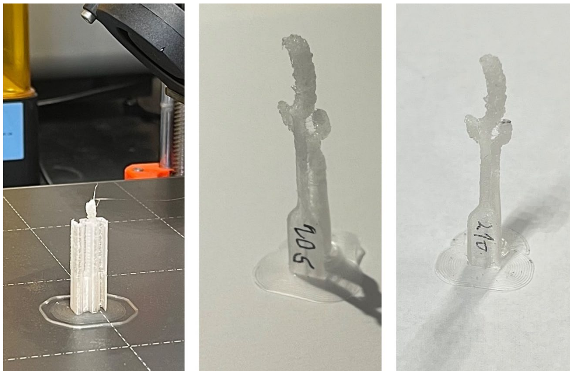
Slika 31. Neuspješni pokušaji ispisa PVB epruveta pod kutom od 90° s različitim potpornim strukturama
