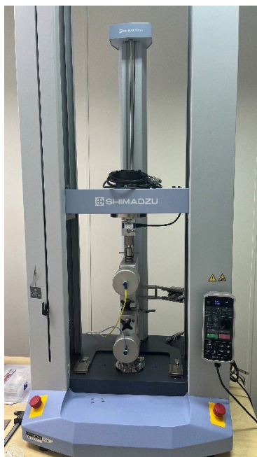
Slika 33. Kidalica SHIMADZU AGS-X 50 kN
