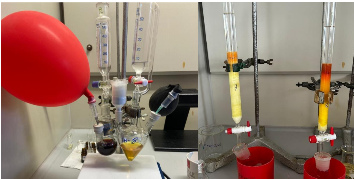
Slika 20. Odvijanje Wittigove reakcije i pročišćavanje dobivenog produkta.
