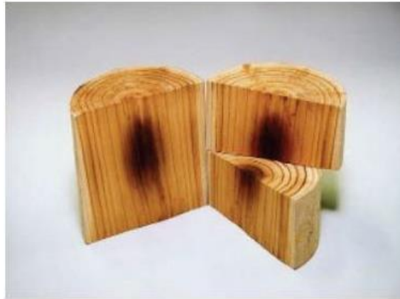
Slika 7. Poprečni presjek drva nakon 3 minute mikrovalnog zračenja
