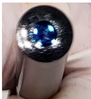
Slika 18. Elektroda od staklastog ugljika modificirana berlinskim modrilom
