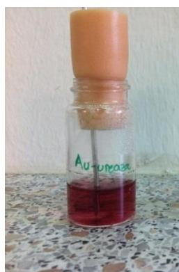
Slika 12. Kotlasti reaktor
