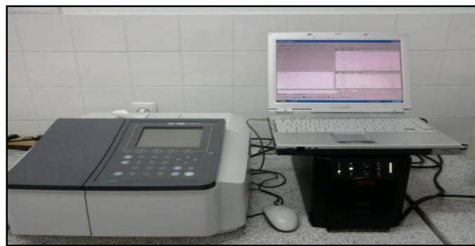
Slika 13. Spektrofotometar Shimadzu UV-1800
