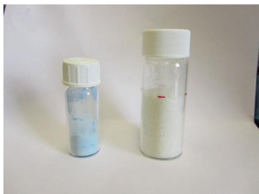
Slika 5 Prikaz obojenog Expancela te usitjenih PLA granula
