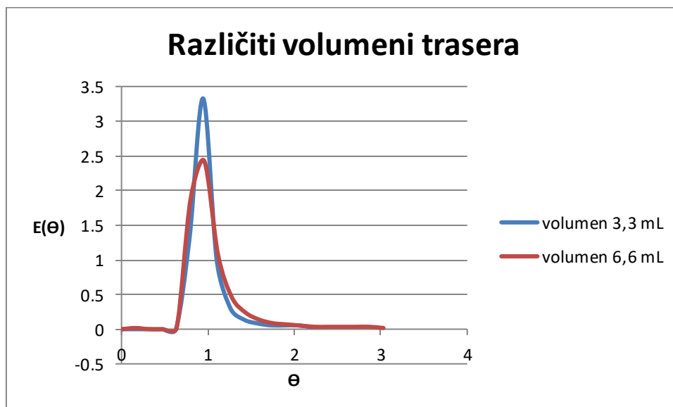
Slika 22. Usporedba E(\Theta) funkcija za različite u cijevi sa staklenim kuglicama pri protoku 600
