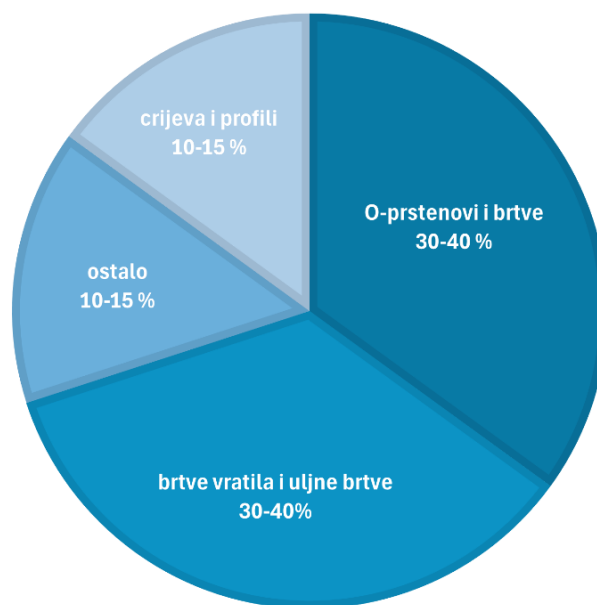
Slika 11. Dijagram distribucije fluoriranih elastomera [22]
