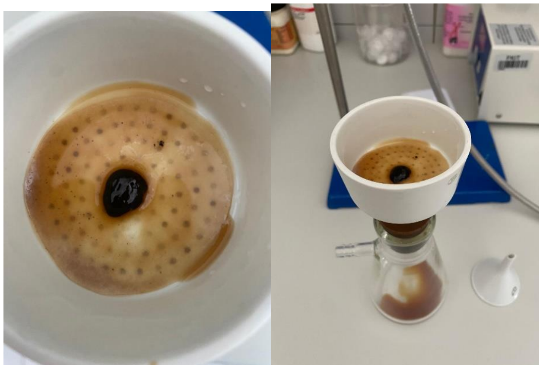
Slika19.: Filtracija produkta s Büchnerovim lijevkom
