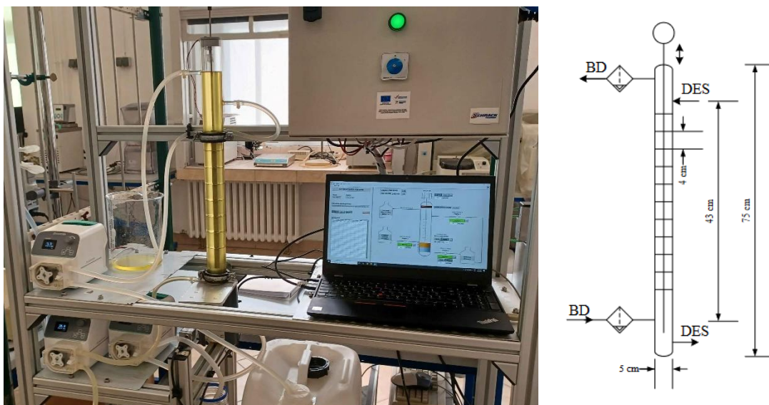
Slika 9. Karrova kolona za kontinuiranu ekstrakciju
