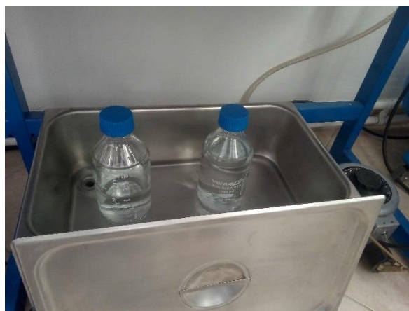
Slika 6. Otapanje KOH u metanolu u ultrazvučnoj kupelji
