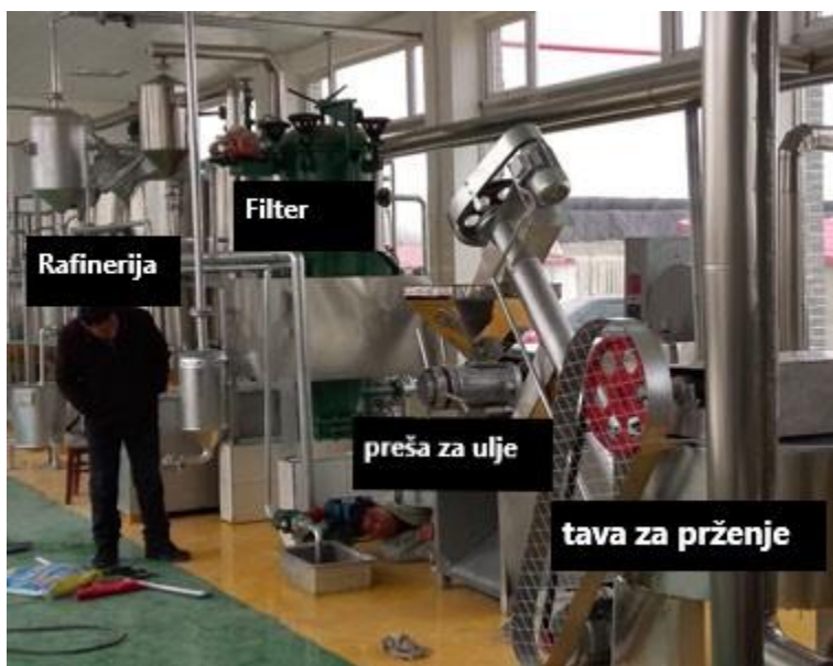
Slika 1. Postrojenje za proizvodnju ulja toplim prešanjem
