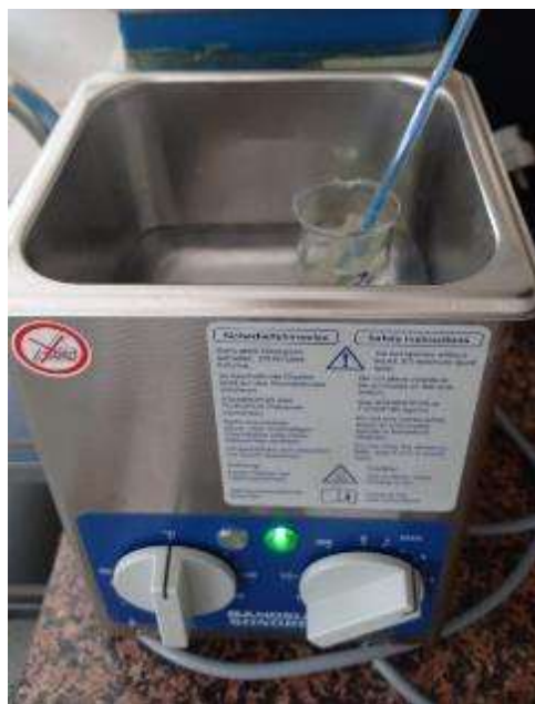
Slika 3.1. Obrada radne elektrode u kupelji
