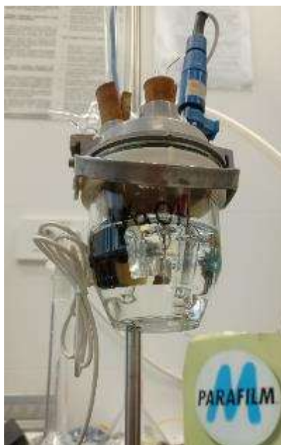
Slika 3.2.. Dušiciranje elektrolita u troelektrodnom mjernom sustavu.
