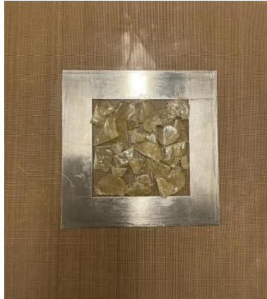
Slika 18. Postavljanje uzoraka u metalni kalup
