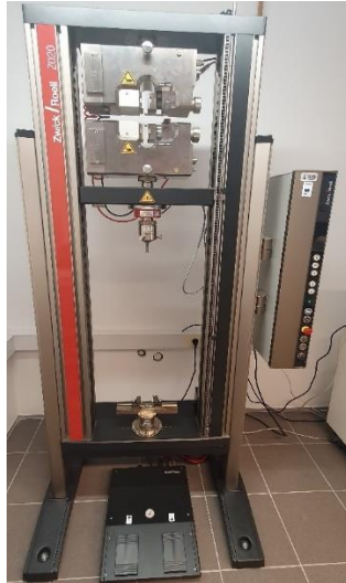
Slika 22. Mehanička kidalica Zwick Roel Z020
