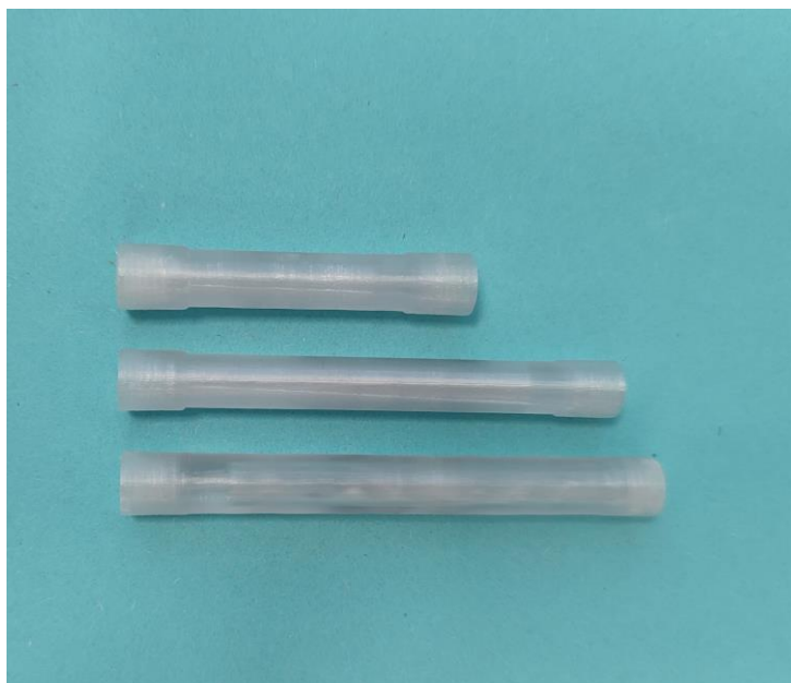
Slika 19. 3D-tiskani cijevni reaktori volumena 300, 500 i 750 \mu\text{L} .
