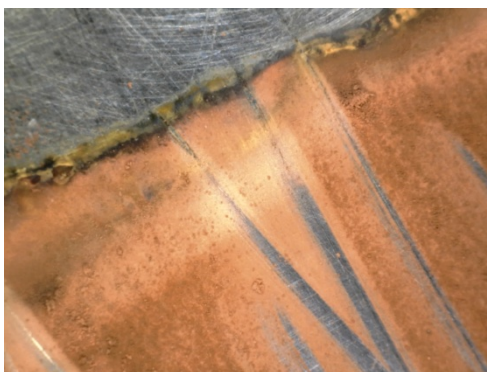
Slika 5.4. Prvi sloj bakra dobiven na površini elektrode pri naponu od 3 V i brzini protoka 17,0 ml/s
