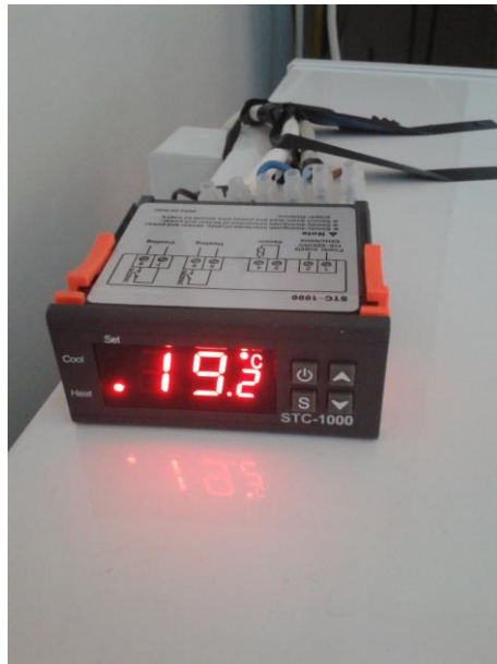
Slika 3-3. Termostat za regulaciju temperature u škrinji.
