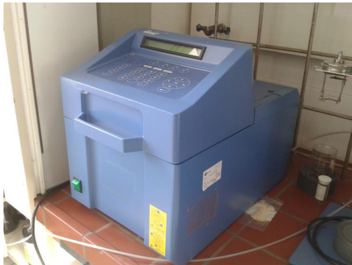
Slika 3-8. Uređaj IKA ® Calorimeter System C 7000 sa hladilom Cooler C 7002.
