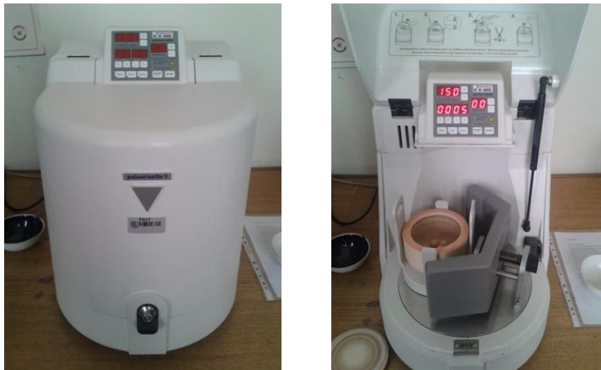
**Slika 3-1.** Planetarni kuglični mlin Pulverisette 6 classic line.
