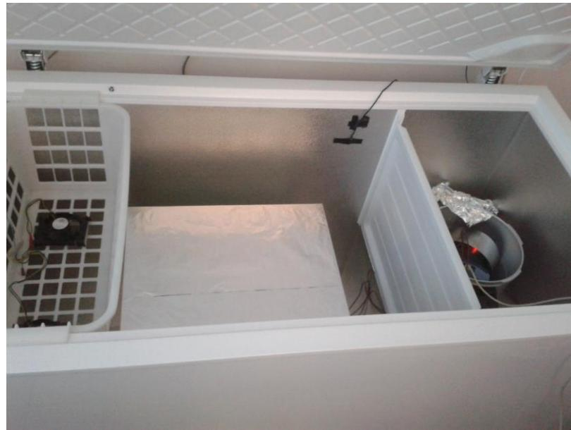
**Slika 3-7.** Aparatura za mjerjenje oslobođene topline prilikom hidratacije.
