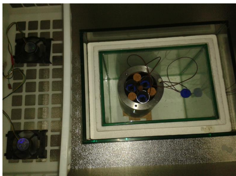
Slika 3-5. Pregled stakleno-stiroporne konstrukcije smještene u škrinju.
