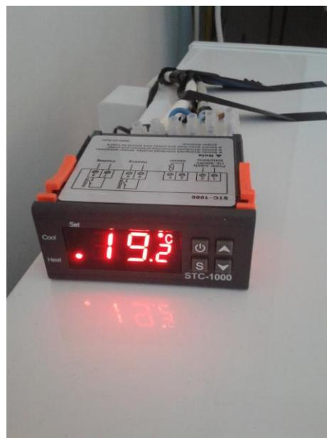
**Slika 3-3.** Termostat za regulaciju temperature u škrinji.
