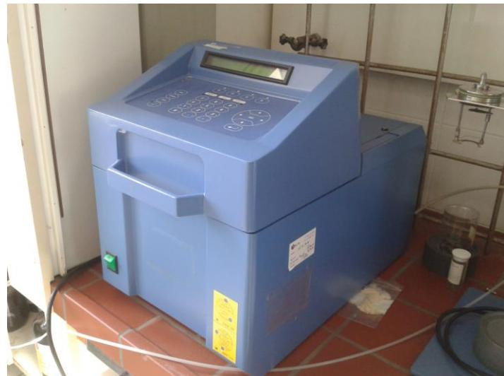
**Slika 3-8.** Uredaj IKA® Calorimeter System C 7000 sa hladilom Cooler C 7002.
