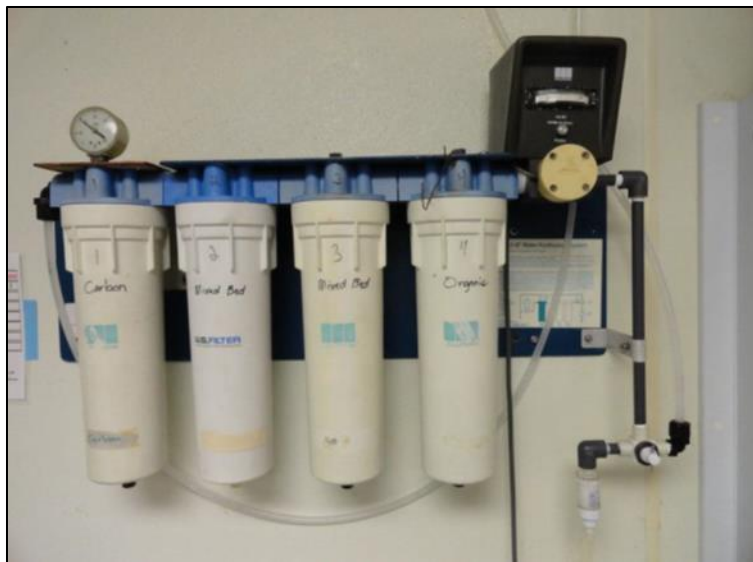
Slika 6. Mili-Q uređaj za dobivanje ultračiste vode
