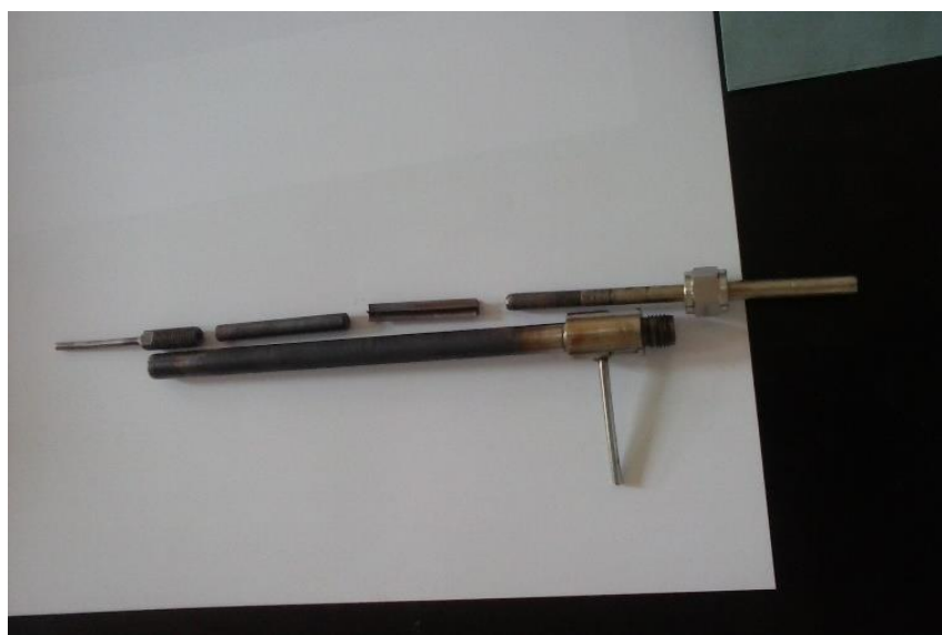
Slika 3.7. Punjenje cijevnog reaktora monolitnim katalizatorom
