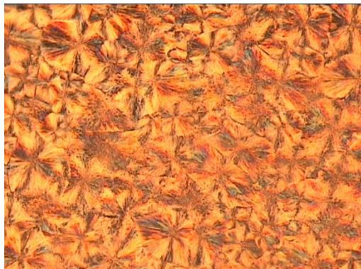
**Slika 53.** Optička polarizacijska mikrografija čistog PU (povećanje 20x)
