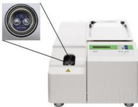
Slika 39. Diferencijalni pretražni kalorimetar, Mettler Toledo DSC 823e
