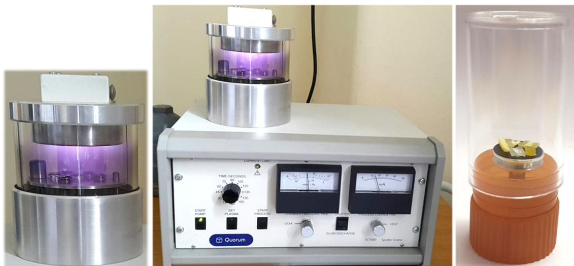
Slika 36. Uređaj za napanje vodljivog sloja zlata i uzorci za napanje
