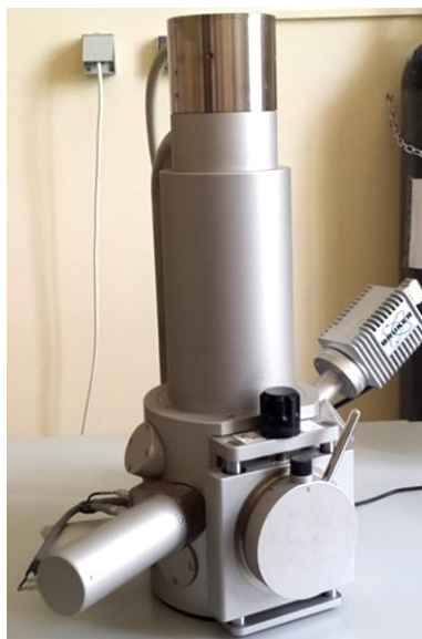
Slika 35. Pretražni elektronski mikroskop Tescan Vega 3, Bruker
