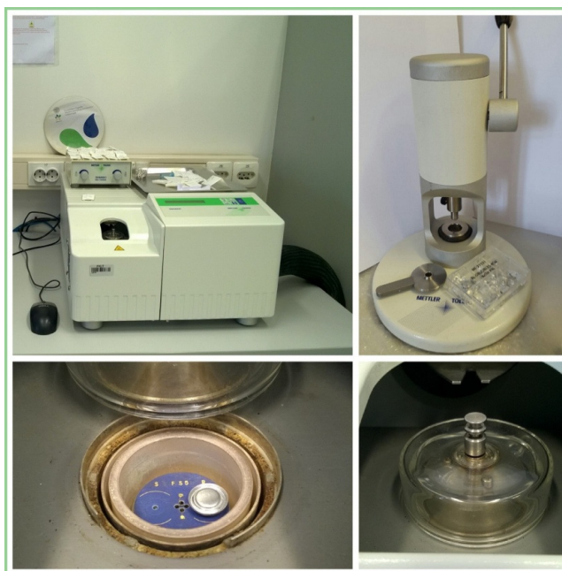
Slika 35. Diferencijalni pretražni kalorimetar Mettler Toledo DSC 823e, prostor za posudicu s uzorkom i referentna posudica, te preša za pripremanje uzoraka
