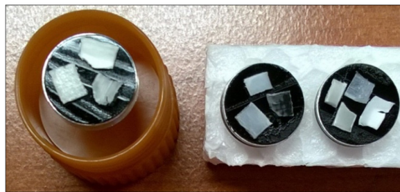
Slika 38. Uzorci na nosačima s ljepljivom trakom prije procesa neparivanja
