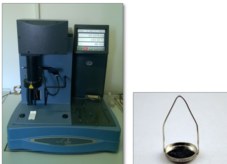
Slika 36. Termogravimetar TA Instruments Q500 i platinska posudica za uzorak [58]
