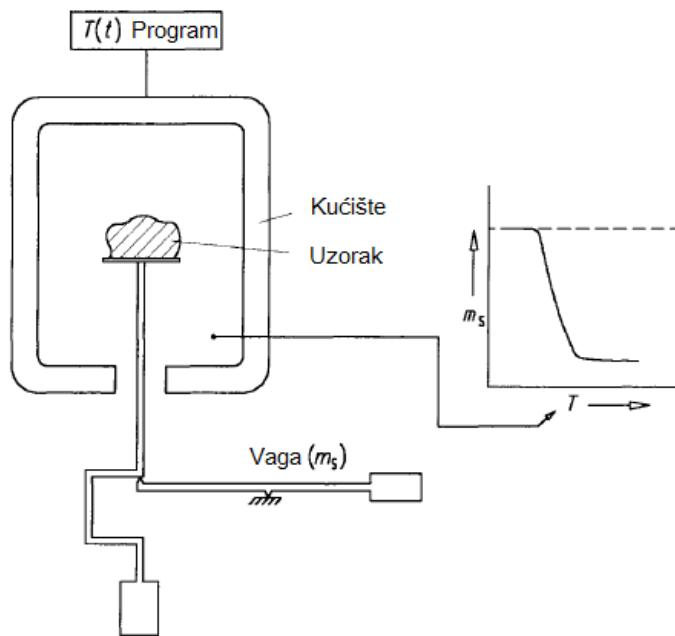
**Slika 19:** Shema termogravimetra<sup>49</sup>
