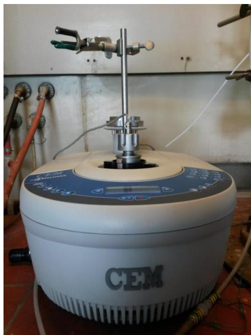
**Slika 3.2.** Kotlasti reaktor s mikrovalovima
