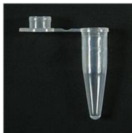
**Slika 3.6.** Prikaz Eppendorf epruvete u kojoj je provođena sinteza izoamil oleata
