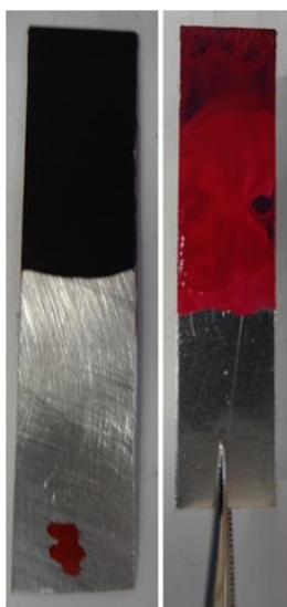
3.3. Izgled elektrode pripremljene za testiranje
