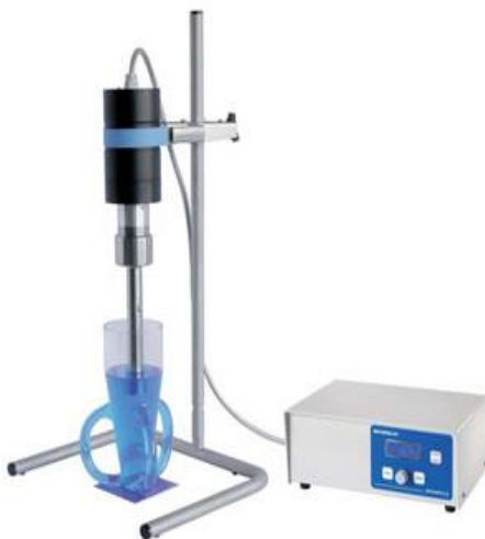
Slika 3.2.1. Ultrazvučna sonda Sonoplus HD 34000
