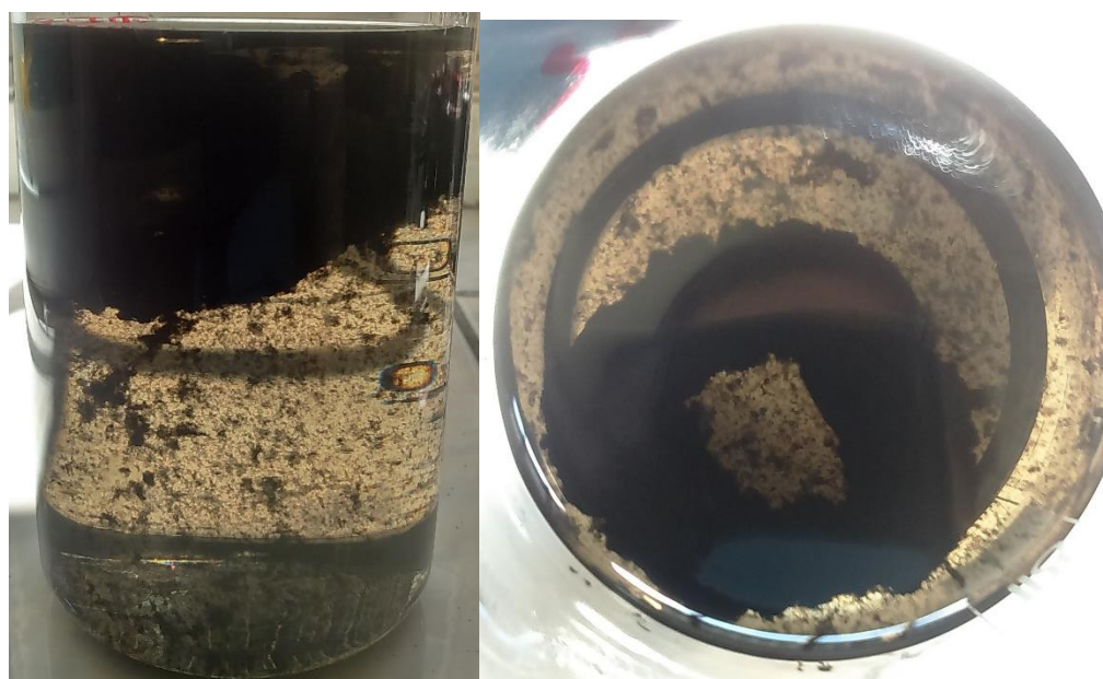
Slika 4.2.15. Uzorak PDPA2 nekoliko sati nakon ultrazvučnog homogeniziranja
