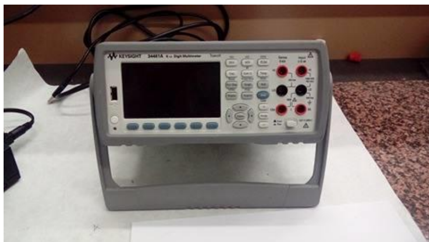
Slika 3.3. Uređaj za mjerenje električnog otpora Keysight 34461 6 1/2 Digit Multimeter
