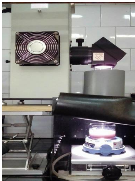
Slika 3.5. Oriel Newport (Osram XBO 450W lampa)
