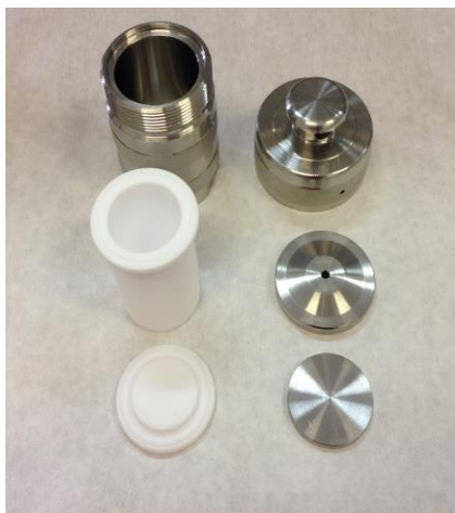
Slika 3.2. Autoklavi korišteni u hidrotermalnoj sintezi
