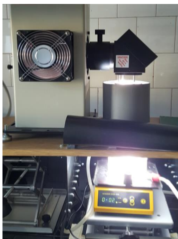
Slika 3.4. Reaktor izložen zračenju solar simulatora
