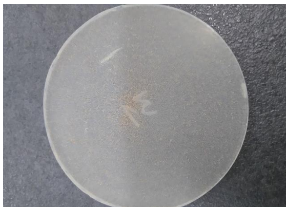
Slika 10. Primjer staklene pločice sa imobiliziranim slojem \text{TiO}_2\text{-SnS}_2 fotokatalizatora
