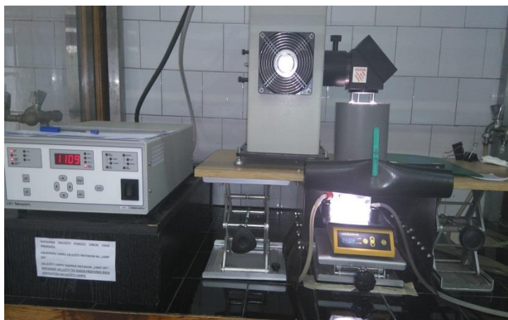
Slika 13. Proces ispitivanja aktivnosti \text{TiO}_2\text{-SnS}_2 fotokatalizatora pod simuliranim sunčevim zračenjem
