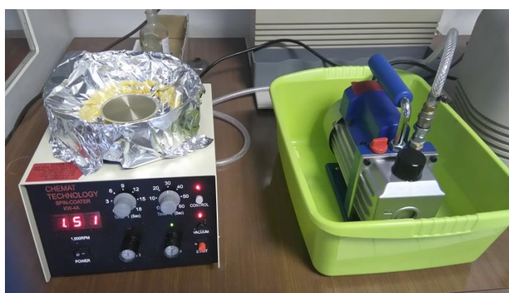
Slika 11. Proces dobivanja tankog sloja fotokatalizatora \text{TiO}_2\text{-SnS}_2 na staklenim pločicama
