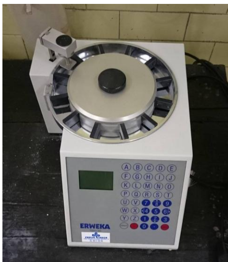
Slika 3.19. Uređaj za ispitivanje tvrdoće i dimenzija tablete
