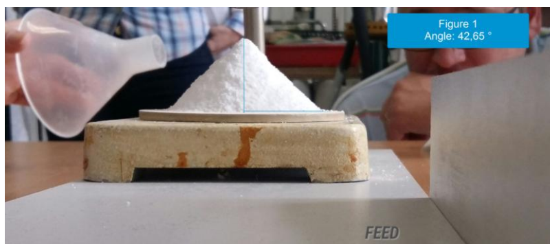
Slika 4.1. Formirani stožac za GAS34
