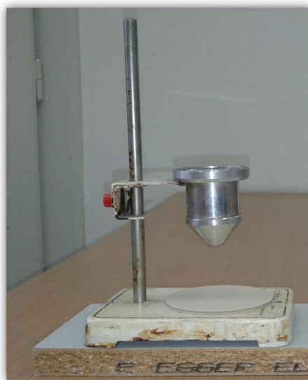
Slika 3.11. Lijevak za određivanje nasipnog kuta
