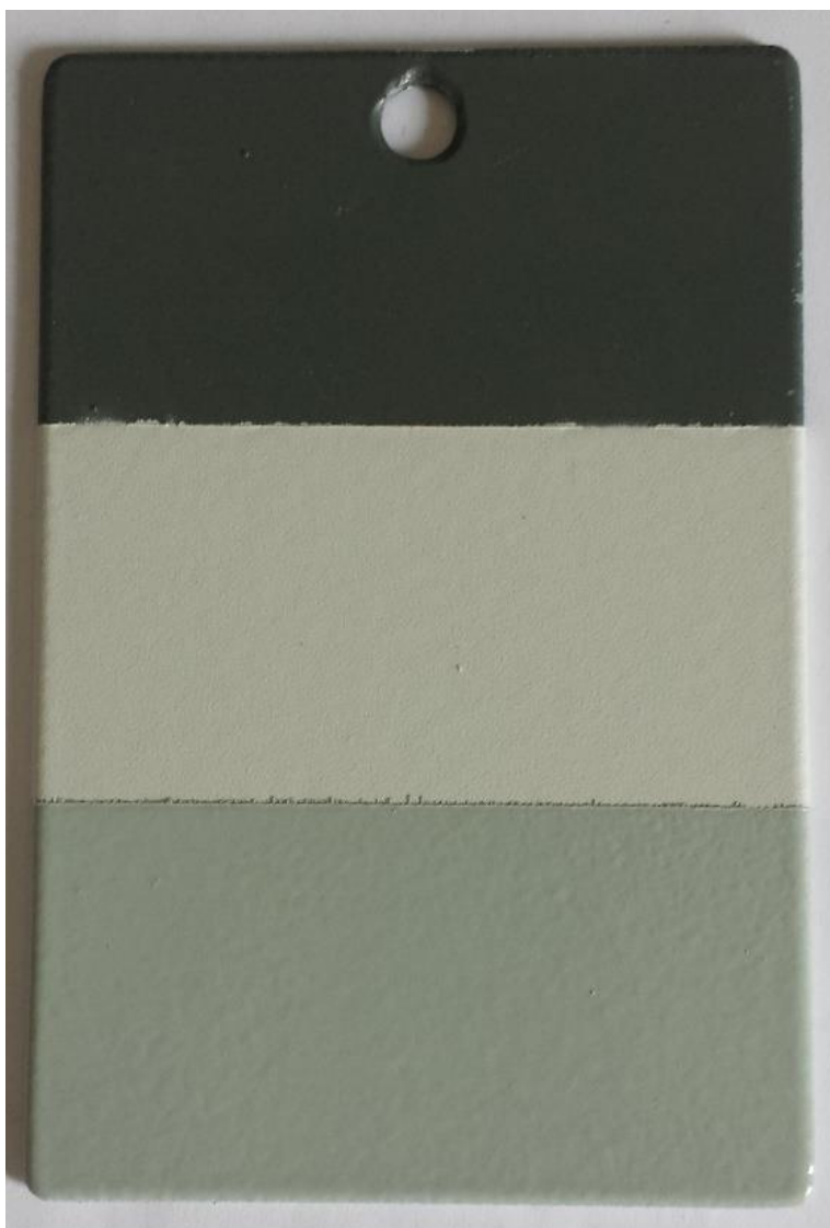
Slika 45. Premazni sustav D po slojevima premaza
