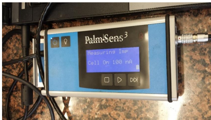
Slika 52. Uredaj za ispitivanje PalmSens 3
