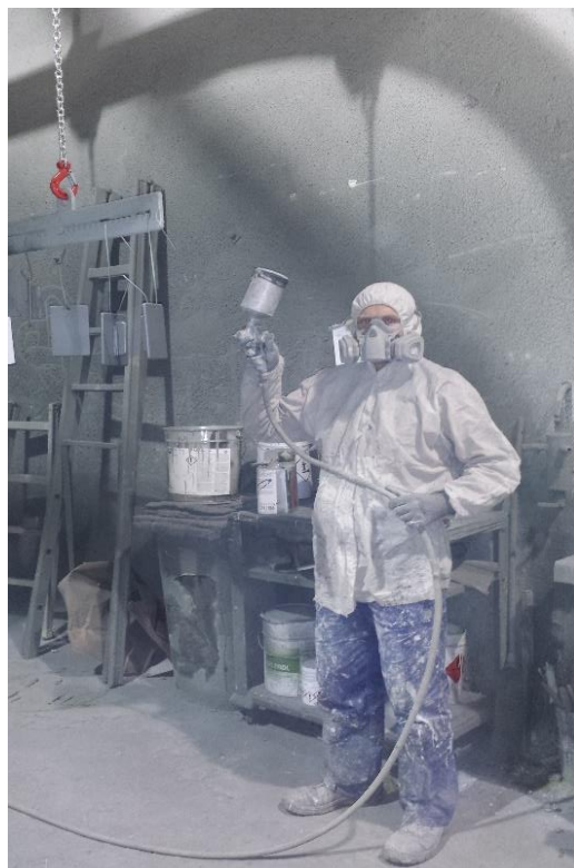
Slika 41. Prikaz procesa nanošenja premaza na testne pločice
