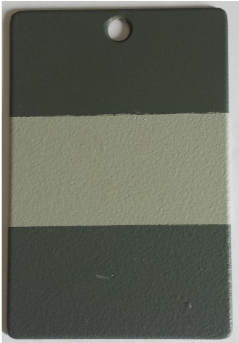
Slika 43. Premazni sustav B po slojevima premaza
