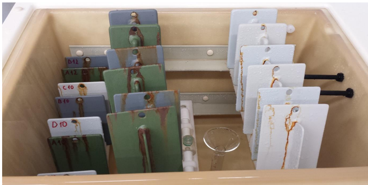
Slika 61. Stanje u slanoj komori nakon 720 sati
