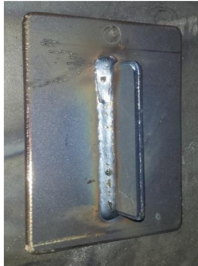
Slika 39. Testna pločica bez rebra i testna pločica s navarenim rebrom
