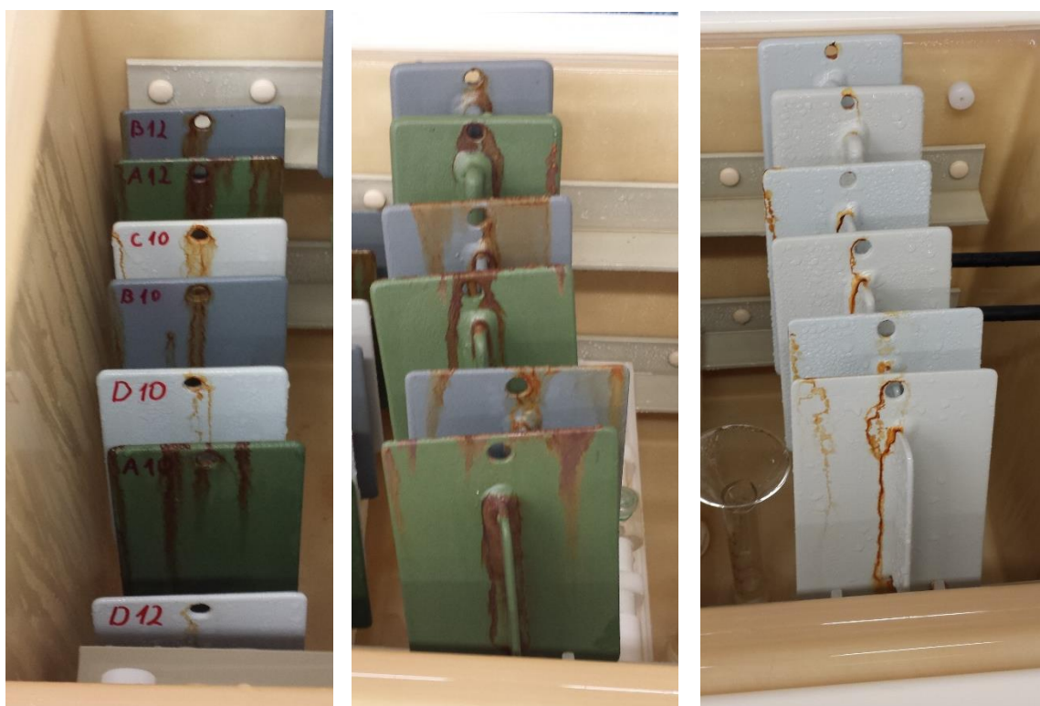
Slika 62. Stanje pojedinih testnih pločica nakon 720 sati
