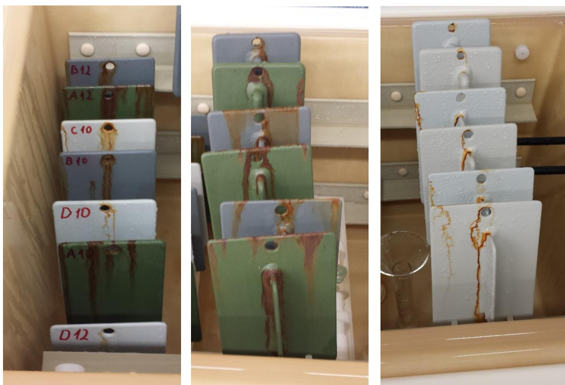
Slika 62. Stanje pojedinih testnih pločica nakon 720 sati
