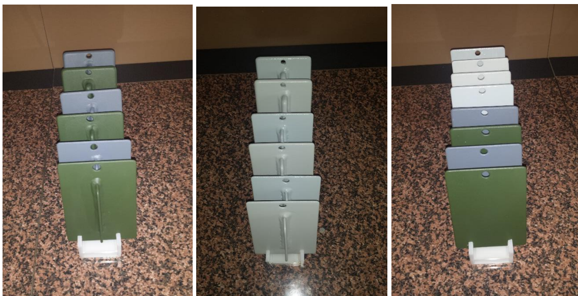
Slika 50. Testne pločice u stalcima prije stavljanja u slanu komoru
