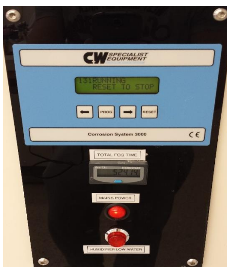
Slika 47. Slana komora SF/100 na Zavodu za elektrokemiju
