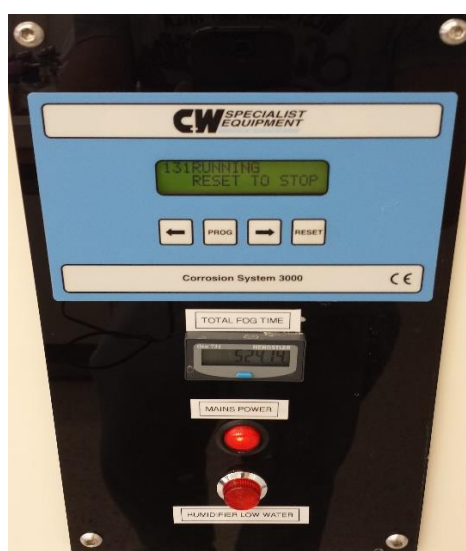
Slika 47. Slana komora SF/100 na Zavodu za elektrokemiju
