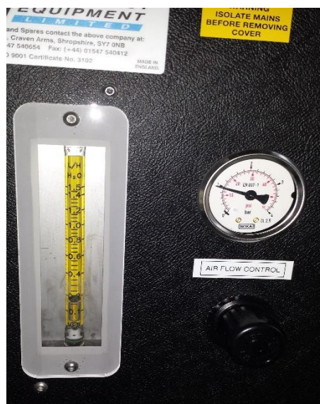
Slika 49. Prikaz parametara protoka i tlaka raspršivanja 5% vodene otopine NaCl
