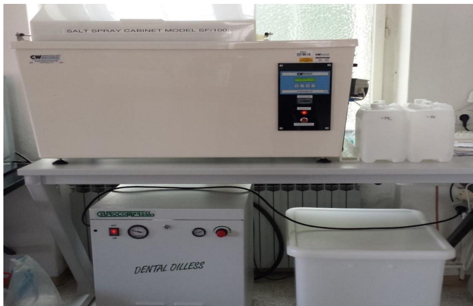
Slika 47. Slana komora SF/100 na Zavodu za elektrokemiju
