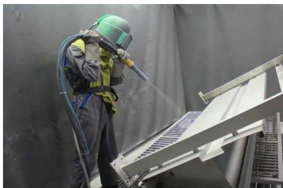
Slika 8. Prikaz mehaničke obrade postupak sačmarenja [14]
