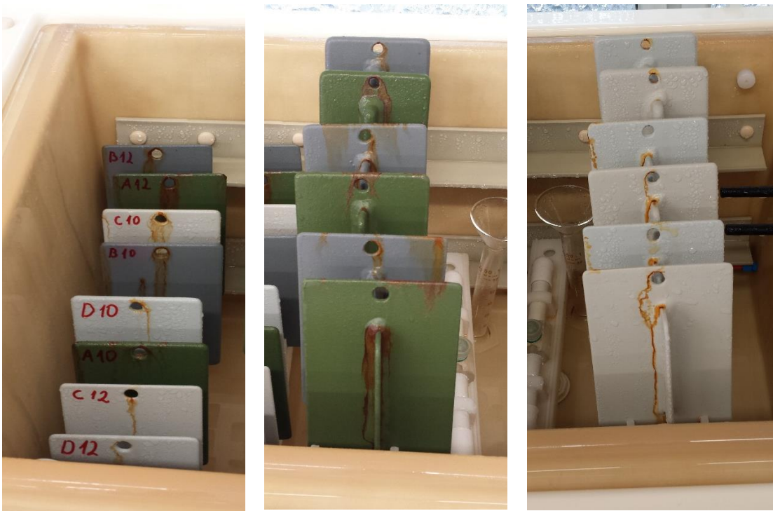
Slika 59. Stanje u slanoj komori nakon otprilike 360 sati
